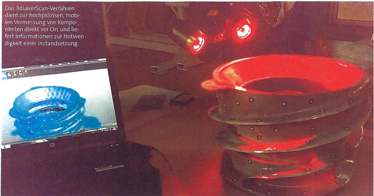
Das 3dLaserScan-Verfahren dient zur hochpräzisen, mobilen Vermessung von Komponenten direkt vor Ort und liefert Informationen zur Notwendigkeit einer Instandsetzung.
