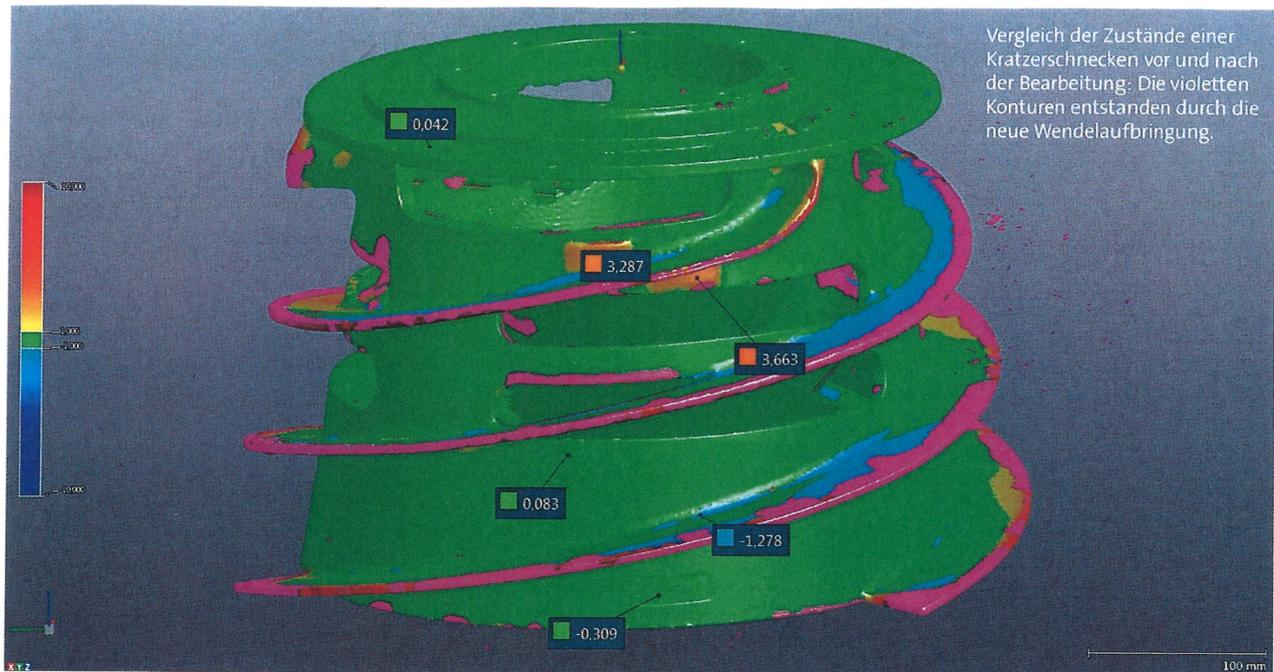
Vergleich der Zustände einer Kratzerschnecke vor und nach der Bearbeitung: Die violetten Konturen entstanden durch die neue Wendelaufbringung.
